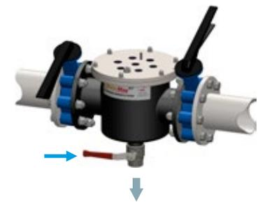
Öffnen Sie das Zulauf-Absperrventil ein Stück und lassen Sie den Inhalt durch das Abflussventil ab. Wenn das abfließende Wasser sauber ist, schließen Sie das Zulauf-Ventil und lassen Sie den verbleibenden Inhalt ablaufen.
