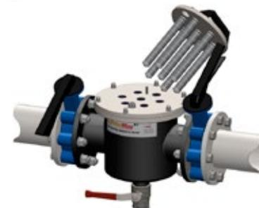
Platzieren Sie einen Auffangbehälter unter der Einheit oder schließen Sie einen Schlauch am 1 1/4" Abflussventil an der Unterseite des BoilerMagXT an. Nehmen Sie die Ablassschraube ab und öffnen Sie das Abflussventil.
